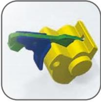
Специальная самопозиционирующаяся контактная система позволяет повысить пятно контакта. При размыкании образует магнитное поле, которое увлекает дугу в дугогасительную камеру
