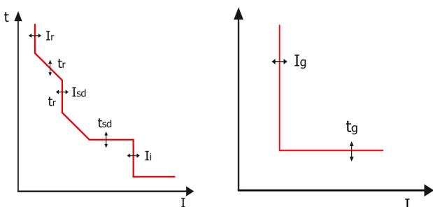
Ток перегрузки  $I_r$ . Задержка по перегрузке  $t_r$ . Рабочий ток – значение уставки  $I_r$  с допуском  $\pm 10\%$ .
