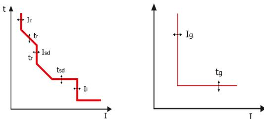
Перегрузка. Задержка по перезагрузке. I<sub>r</sub> – рабочий ток. Значение уставки I<sub>r</sub> тока с допуском ±10%.
