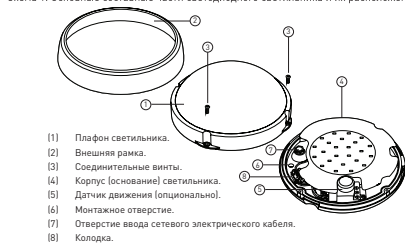
Схема 2. Микроволновой датчик движения
