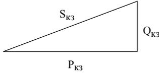
Рисунок Б.2 – Треугольник мощностей короткого замыкания трансформатора
