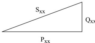
Рисунок Б.3 – Треугольник мощностей холостого хода трансформатора
