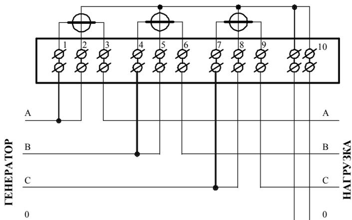
Примечание - Соединения 1-2, 4-5, 7-8 могут быть произведены перемычками, входящими в состав комплекта счетчика
