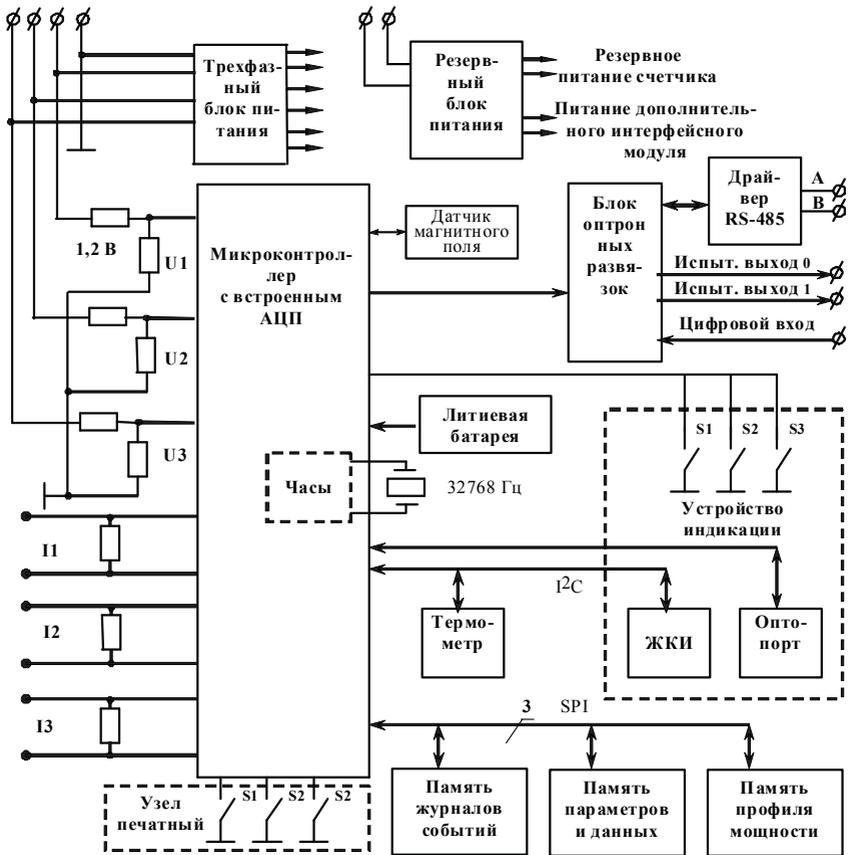
Рисунок 3 – Структурная схема устройства управления
