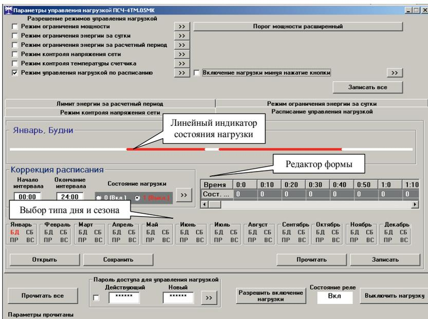
Рисунок 33 – Вкладка «Расписание управления нагрузкой»
