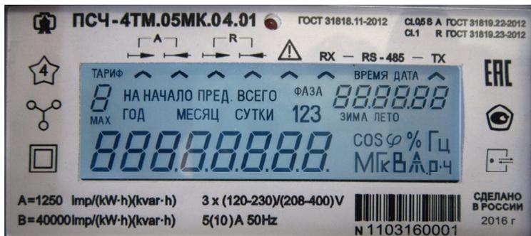
Рисунок 5 – Внешний вид ЖКИ с включенными элементами индикации
